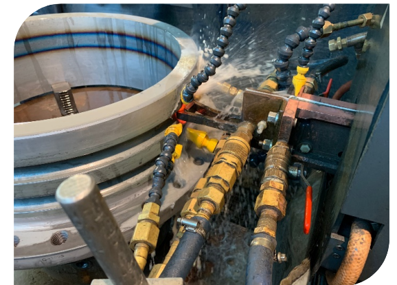
Индукционная закалка соединения для увеличения срока службы и грузоподъемности
