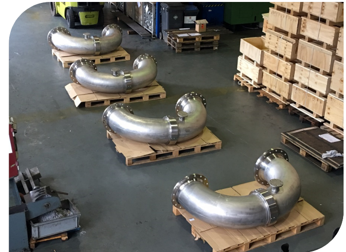
ATN Вращающиеся соединения размера DN400 (16") из нержавеющей стали (1.4301) для систем аспирации в резервуарах для хранения топлива
